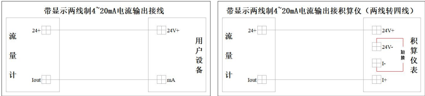
图 8 两线制（4~20）mA 输出接线示意图
