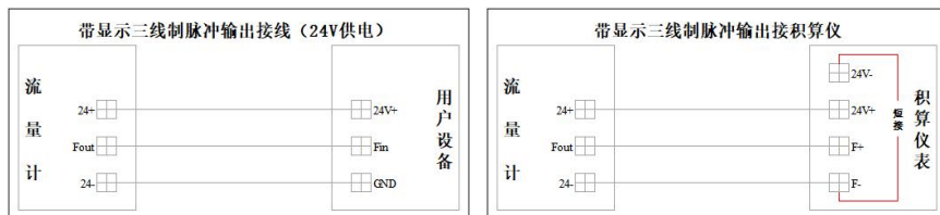
图 11 脉冲输出接线示意图
