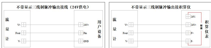
图 6 脉冲输出接线示意图
