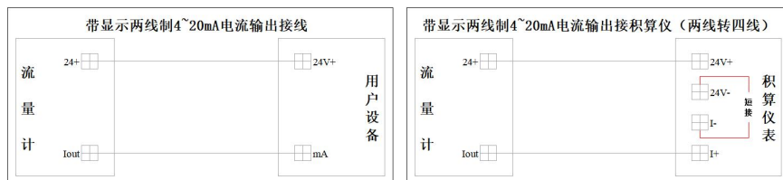
图 9 两线制（4~20）mA 输出接线示意图
