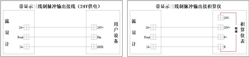
图 12 脉冲输出接线示意图
