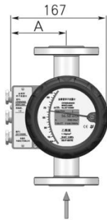
a、下进上出型标准型及夹套型配 M30 指示器外形尺寸及重量
