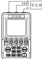
图 6 测量三线制变送器
