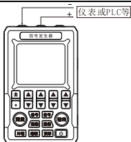
图 2 输出有源电流/电压到仪表或 PLC
